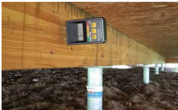
Obr. 10: Kontrola vlhkosti modřínových hranolů po třech letech (naměřená vlhkost 11,7 %)
