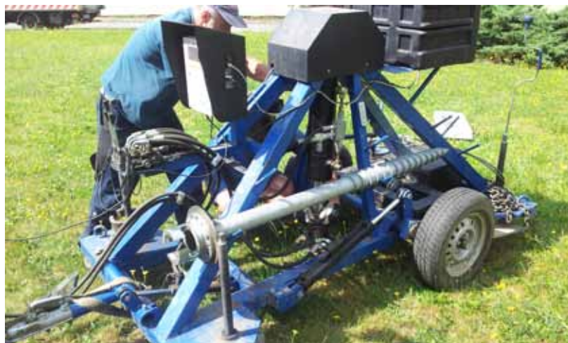
Obr. 3: Příprava zařízení pro měření únosnosti zeminy
